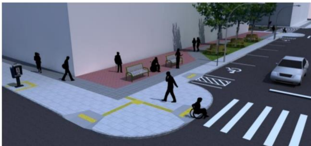
Calçada com desvio na faixa acessível.
