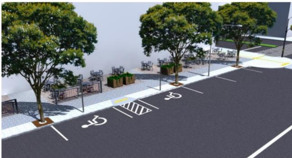
Rebaixo de calçada de acesso a área reservada para veículos de pessoas com deficiência
