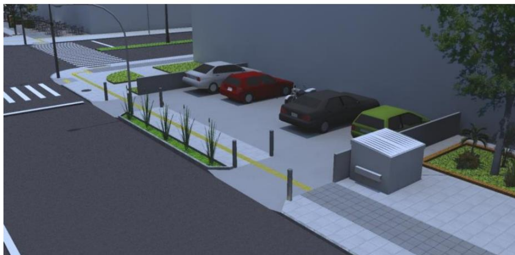
Calçada com rebaixamento do meio fio para acesso de veículos ao estacionamento.
