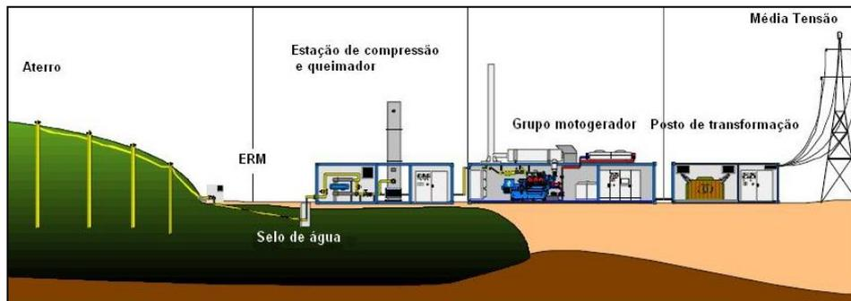
Figura 9 – Modelo de estrutura necessária para o aproveitamento do Biogás.
